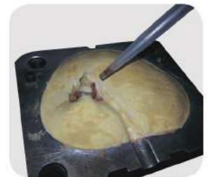
16. Applicare una goccia di Fusing Liquid con un contagocce o un pennello sulla zona da riparare. Chiudere e iniettare.
