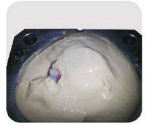
12. Mettere il caso in muffola avendo cura di ricoprirlo di gesso ovunque tranne nella zona da riparare.
