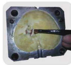
15. Applicare EZ Flow Separator solo sul gesso.
